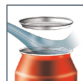
Dispositivo iniezione azoto/CO2
